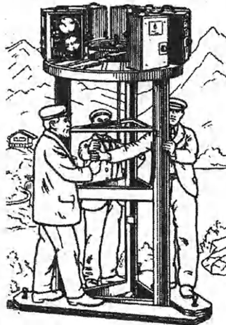
Fig. 2. Camera configuration for Raoul Grimoin-Sanson's Cinécosmorama or 'Cineorama', patented on 27 November 1897 © Cinémathèque Française
